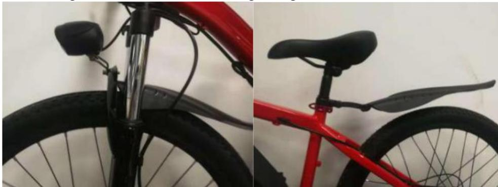
(5) Befestigen Sie das hintere Schutzblech an der Sitzstange.
